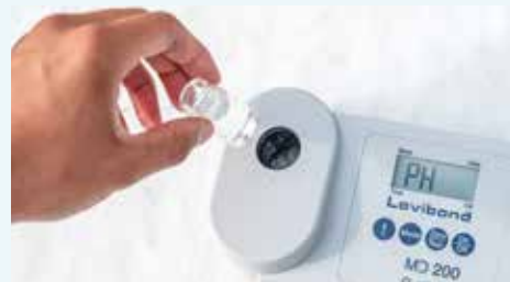
Ph-Wert Überprüfung der Wasserprobe.
