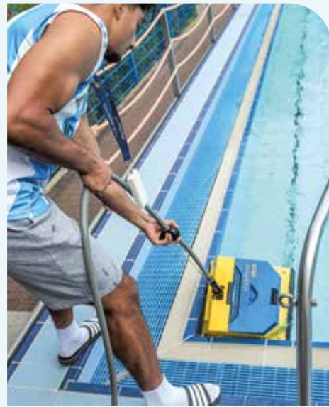
Beckenreinigung mit einem Wasserstaubsauger.
