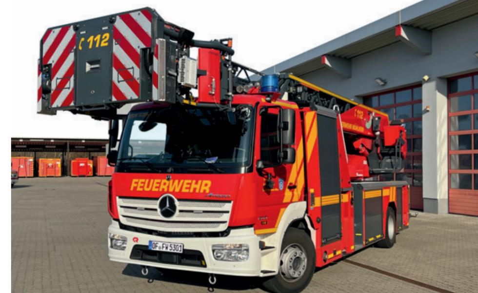
Aus dem aktuellen Fuhrpark: DLK 23/12 (Drehleiter mit Korb) – durch seine Vielseitigkeit wichtiger Bestandteil des Löschzuges bei Brand- und Hilfeleistungseinsätzen. Die Drehleiter kann bis auf 30 m ausgefahren werden.
