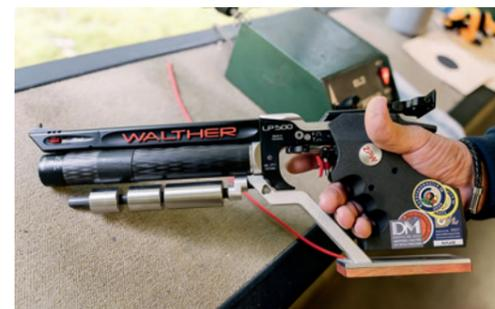
Die Luftpistole ist speziell für das Auflage-schießen konzipiert, mit Gewichten und einem besonderen Griff.
